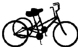
Параллельный тандем L = 1800 - 1950 мм / W <1070 мм
