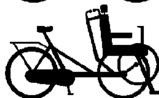
Трицикл/трехколесный велосипед, включая инвалидный L = 1400 - 2100 мм / W <850 мм
