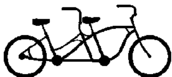
Последовательный тандем L = 2100 - 2500 мм / W <750 мм
